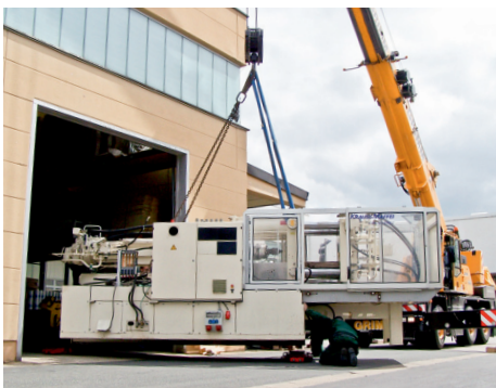
Anlieferung der neuen Linsenspritzguss-Maschine
